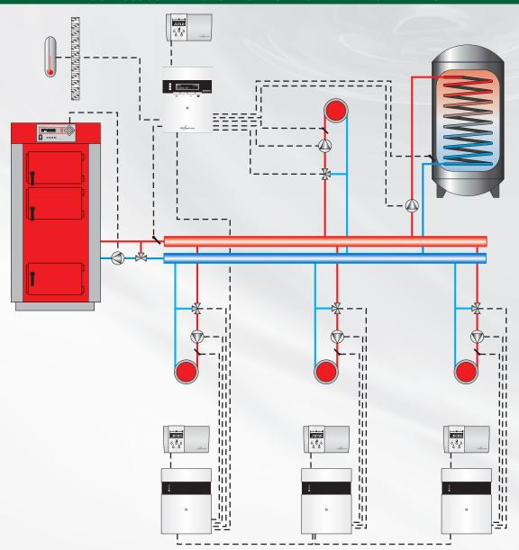
Beispielschema einer Heizinstallation mit DKMATIC-Controller mit drei angeschlossenen Erweiterungsmodulen DKMZ1: Kreislauf 3, Kreislauf 4 und Kreislauf 5. Ohne Absperr- und Schutzvorrichtungen. Ersetzt nicht das Fachprojekt am Montageort.
