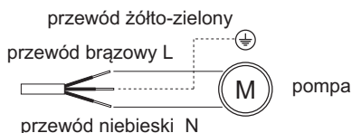
Rys. 6 Schemat podłączenia przewodu do pompy
