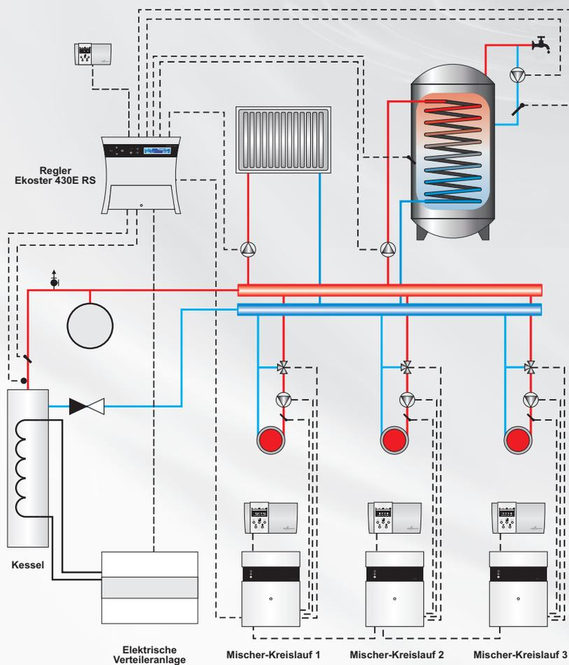
Beispielschema der Heizanlage mit angeschlossenen drei Erweiterungsmodulen DKMZ 1 Mischer-Kreislauf 1, Mischer-Kreislauf 2 und Mischer-Kreislauf 3. Dieser ersetzt nicht das professionelle Projekt am Montageort.
