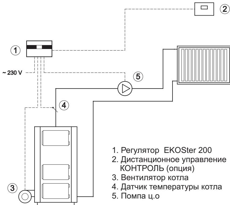
Рис. 4 Подключение регулятора к инсталляции центрального отопления
